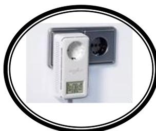
Le **CPL** (courant porteur de ligne) utilise le réseau électrique du bâtiment (ce qui est très pratique pour éviter de rajouter des câbles). Un premier boîtier fusionne l'information et l'alimentation au départ, l'autre boîtier sépare le signal pour récupérer l'information. La portée est limitée au bâtiment.
