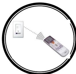
L'**infrarouge** utilise des ondes lumineuses invisibles à l'œil humain. La distance de fonctionnement est très courte et nécessite l'absence d'obstacles. On l'utilise par exemple pour les télévisions.
